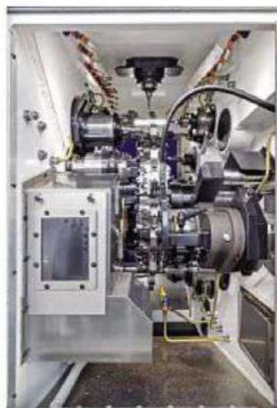
Macchina da barra Buffoli TRANS-BAR standard 12 stazioni per la lavorazione di pezzi torniti in ottone senza piombo
